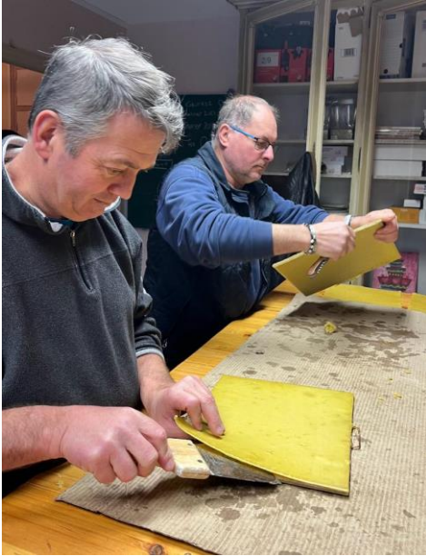
Séparation feuille de cire du support bois avant laminage
