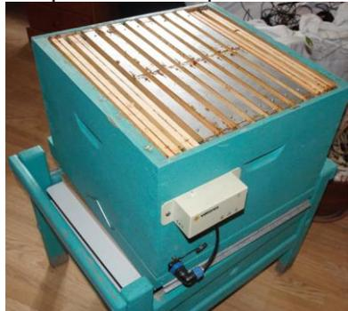
*Ruche 12 cadres avec 8 cadres VATOREX, une balance électronique et une sonde de température du couvain*
